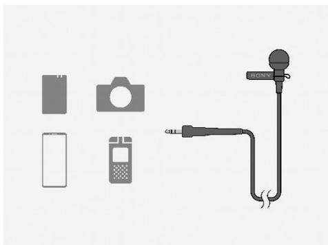
ECM-L1 領夾式麥克風支援插入式電源，由連接的設備供電。可連接到<sup>1</sup>各種配備 3.5 毫米麥克風插口的設備，如相機、智能手機、無線麥克風、IC 錄音機和電腦等，實現高品質音訊錄製，滿足不同環境的需要。
