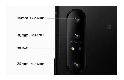
**Xperia 1 II** 的快速對焦功能亦可於昏暗的環境下使用,結合四項精湛影像技術,包括 Dual Photo Diode 感測器 $^{vii}$ 、覆蓋約 70% 感測器範圍的自動對焦系統 $^{vii}$ 、3D iToF 感測器  $^{viii}$ 及全新 1/1.7 吋「Exmor RSTM for mobile」特大影像感測器,令拍攝靈敏度比以往型號高 1.5 倍,即使在低光的環境下仍可快速及準確地對焦。
