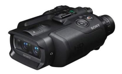
有別於傳統雙筒望遠鏡,當 DEV-5 啟動電子自動對焦系統,即使目標處於動態仍可保持清晰無誤;同時,機身上的旋鈕設置亦令手動對焦方便易用。用戶可選擇只向目標對焦,從而避免採用自動對焦時或會因視野內出現懸掛的樹枝或其他障礙物的影響。憑藉電子自動對焦,該望遠鏡錄攝 2D 影片時可在只有 1 釐米近距離向目標進行清晰對焦(3D 影片錄攝的最近距離為80 釐米),非常適合放大近距物體及方便遠距觀察。
